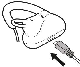
完全にバッテリーを充電するには約 2 時間かかります。ヘッドセットのバッテリーが完全になくなった場合、15 分の充電で 1 時間のバッテリー時間が得られます。
