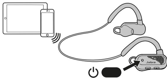
ヘッドセットの電源をオンにし、音声ガイダンスの指示に従い、スマートフォンとペアリングします。
