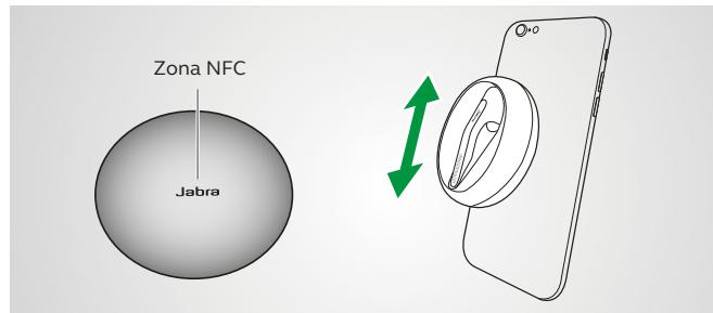
Deslice la zona NFC de la carcasa de carga sobre su smartphone con NFC hasta que se confirme la sincronización.
